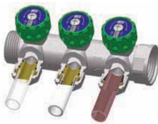
Рис. 37. Присоединение к отводам с метрической резьбой M24x19
